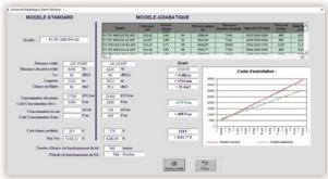
Das Auswahlprogramm umfasst eine Datenbank mit Daten meteorologischer Aufzeichnungen, die eine stundenweise Einschätzung des Rückkühlerbetriebs an 365 Tagen pro Jahr für 60 unterschiedliche geografische Gebiete ermöglicht. So ist mit dem Auswahlprogramm eine präzise Berechnung der Betriebskosten und Vorteile möglich, die die adiabatische Kühlung an Ihrer Anlage mit sich bringt.
