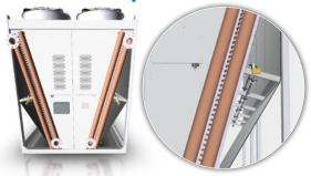
**AAS** ist ein adiabatisches System. Durch Besprühen von Wasser auf einen Gewebevorhang aus Polypropylen vor dem Wärmetauscher, wird eine Vorkühlung der Luft erziehlt. Dieses System zeichnet sich im Vergleich zu einem klassischen adiabatischen System durch Folgendes aus:
